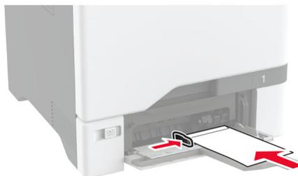
**Warnung—Mögliche Schäden:** Es dürfen keine Umschläge mit Briefmarken, Metallklammern, Haken, Fenstern, Fütterung oder selbstklebenden Klebeflächen verwendet werden.
